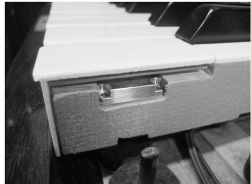
図 2：鍵盤に組み込んだ力センサ
